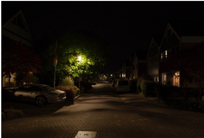
Foto: Voorbeeld van een boom die in het groen staat waardoor er veel licht op straat wegvalt.
