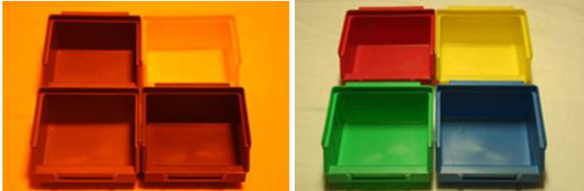
Foto: Oranje sox licht, alles lijkt rood/oranje Foto: wit licht, alle kleuren zichtbaar
