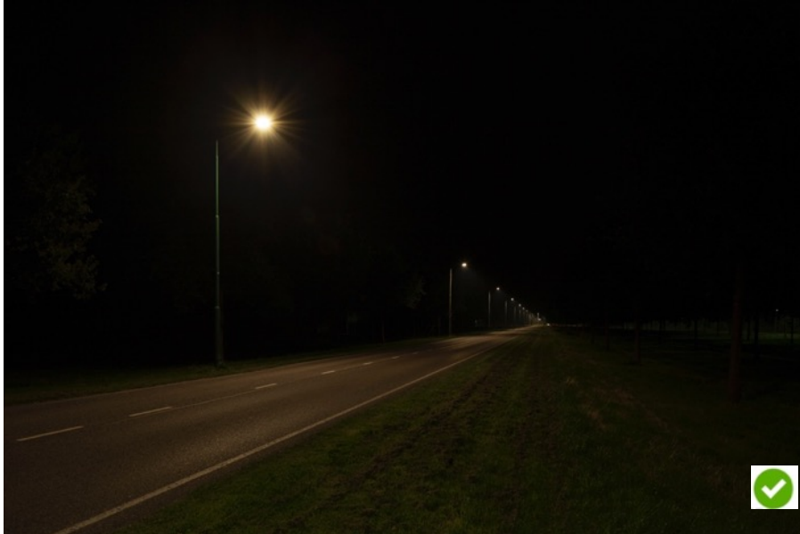
Foto De West in Dronten. Licht brandt op halve sterkte tussen 00.00 en 06.30 uur. Er is minder verkeer op straat, de ogen zijn gewend aan donker, minder lichthinder en we besparen energie.
